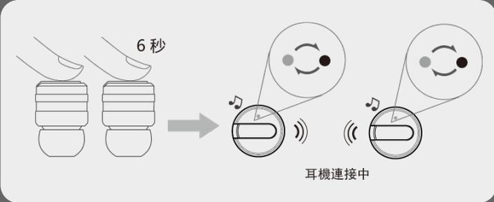
兩個耳機將自動互相連接，左右耳機連接上之後，一個耳機藍燈慢閃，一個耳機紅藍燈交替閃爍，此耳機即為主耳機也為立體聲時左聲道，此時手機上只顯示一個”Nakamichi TW1”。
